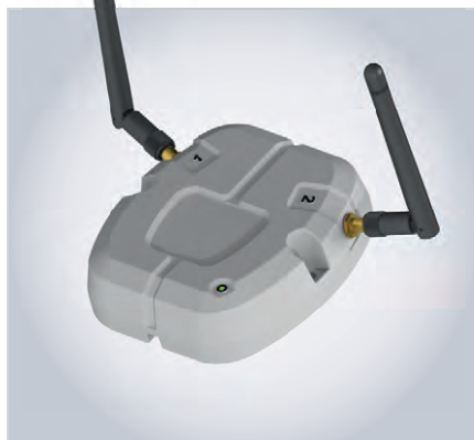
Рис. 5. Базовая станция с внешними антеннами
