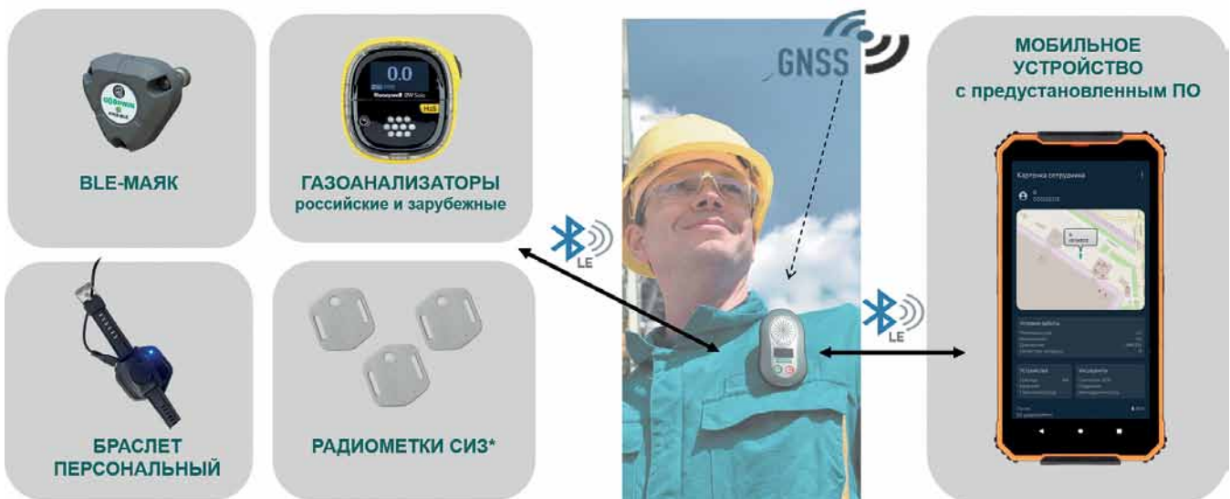
Рис. 4. Состав системы мониторинга персонала LoRaMesh
